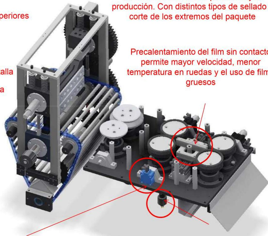
Sistema para evitar la soldadura longitudinal deteriorada en las paradas, cada vez que la máquina se detiene las ruedas se abren automáticamente
