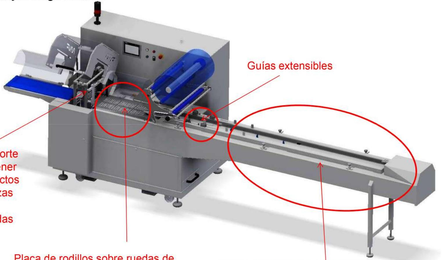
Grupo de soldadura y corte con varillas para mantener la posición de los productos a través de las mordazas
